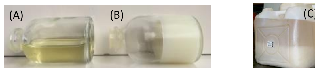
Figura 3. Biodiesel metílico de palma: (A) T > Ponto de Fluidez; (B) T < PP; (C) óleo de palma em T.A. < 10 °C (LEQUIPE/UFPR).
