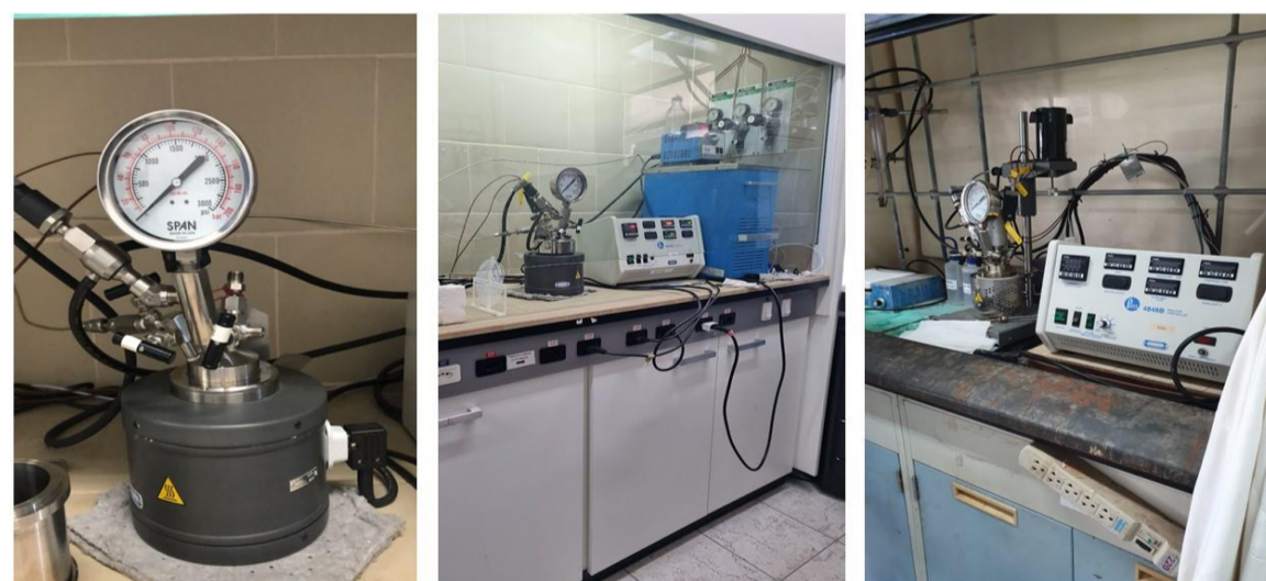
Figura1- Reator Parr 4348 do Laboratório professora Arlene Gonçalves Correa do DQ-UFSCar
