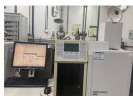
Cromatógrafo Gasoso 3800 - Varian -Detector PDHID -Criogenia -Dióxido de carbono líquido -Nitrogênio líquido
