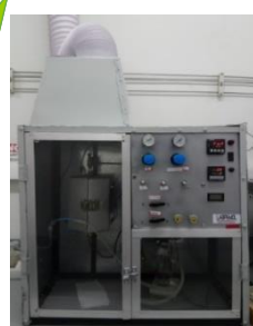
Reator usado na ativação do catalisador. Fonte: SANTOS, 2019.
